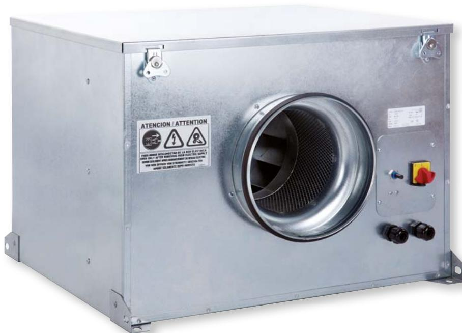
Lüftungsboxen aus verzinktem Stahlblech und niedrigem Profil sowie einer 50 mm starken feuerfesten Schalldämmauskleidung aus Glasfaser (M0), mit schallabsorbierender Isolierung am Einlass. Alle Modelle besitzen am Einlass und Auslass runde Verbindungsflansche mit Gummilippendichtungen. Freilaufender, rückwärts gekrümmter Radialventilator. Bürstenloser EC-Motor, IP44, mit thermischem Überlastschutz, geeignet für Wechselstromversorgung 230 V,  $\pm 15\%$ , 50/60 Hz.
