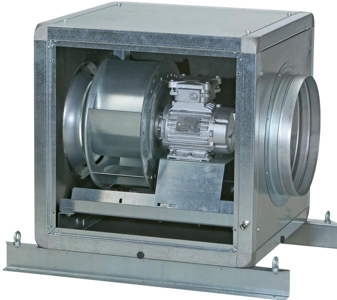
Schallgedämmte Lüftungsboxen mit freilaufenden, rückwärts gekrümmten Radiallaufrädern. Entwickelt für die Entrauchung im Brandfall mit F400-120 Zertifizierung (CE-Kennzeichnung). Das Gehäuse ist aus verzinktem Stahl mit robustem Rahmen und Schalldämmauskleidung 25 mm, nicht brennbar (M0). Alle Modelle sind standardmässig mit Motoren der Temperaturkategorie F400-120 ausgestattet.
