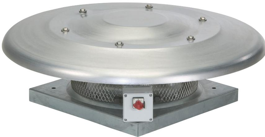
Baureihe von Radialventilatoren für die Dachmontage mit horizontalem Luftaustritt, sehr niedriger Höhe, Sockel aus verzinktem Stahlblech, Aluminiumhaube, rückwärts gekrümmtem Radiallaufrad (aus Kunststoff bei den Modellen 225 und 250 und aus Aluminiumblech bei den Modellen 280 bis 630), Vogelschutzgitter, Aussenläufermotor mit Thermoschutz und standardmässiger Revisionschalter.
