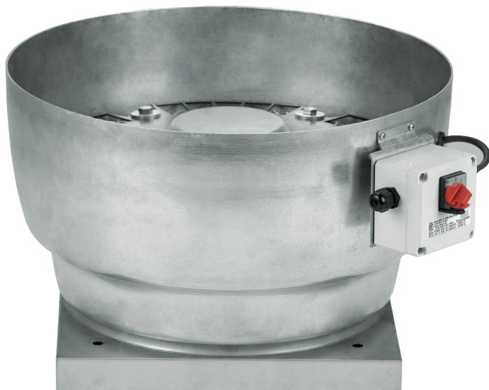
Vertikal ausblasende Dachventilatoren. Sockel aus verzinktem Stahlblech, Aluminiumhaube, rückwärts gekrümmtem Radiallaufrad (aus Kunststoff bei den Modellen 225 und 250 und aus Aluminiumblech bei den Modellen 280 bis 630), Vogelschutzgitter, Aussenläufermotor mit Thermoschutz und standardmässiger Revisionschalter.
