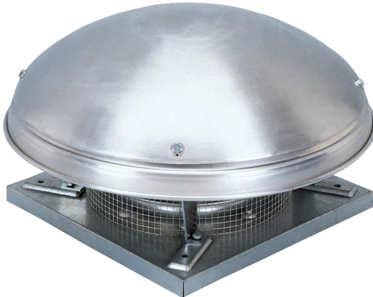
Horizontal ausblasende Radial-Dachventilatoren für Entrauchung im Brandfall. F400-120-Zertifiziert (1) und geeignet für Fördermitteltemperaturen bis 120°C im Dauerbetrieb.
