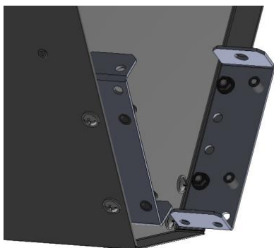
Installation des Verbindungsstücks im Luftschleier
