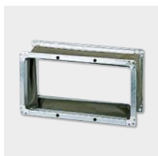
EVD NV Elastische Verbindung druckseitig Zur Reduzierung von Körperschall. Kanalseite mit 20 mm Normflansch.
