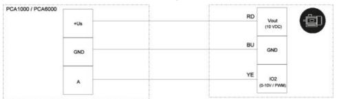
Klemmkasten mit verdrahtetem Potentiometer
