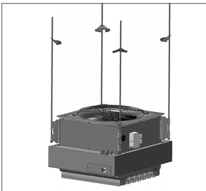
Abb. 4-5: Deckenmontage des Umluftgerätes mit Deckenaufhängung (ZH#.560#)
