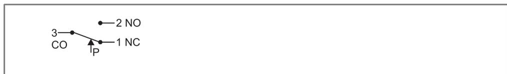
Abb. 5-8: Anschluss Differenzdruckschalter
