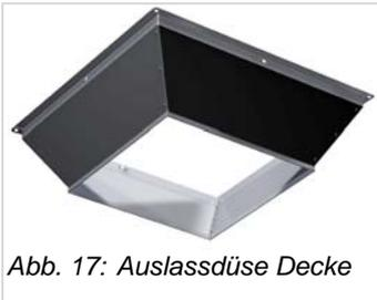
Aus verzinktem Stahlblech gefertigte, quadratisch eingeschnürte Düse. Die Luftgeschwindigkeit wird dadurch erhöht und ermöglicht so größere Montagehöhen.
