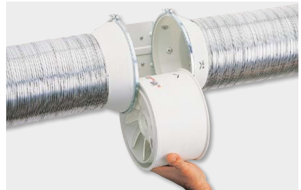
Das einzigartige Design der Montagekonsole ermöglicht den Ein- oder Ausbau der Motoreinheit ohne Demontage der Rohrleitung
