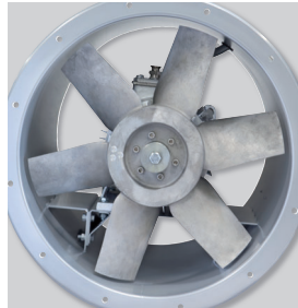
Dynamisch ausgewuchtetes Laufrad Laufrad aus Aluminium gegossen aus einem Stück. Dynamisch ausgewuchtet, gemäß ISO 1940, für einen vibrationsfreien Betrieb.
