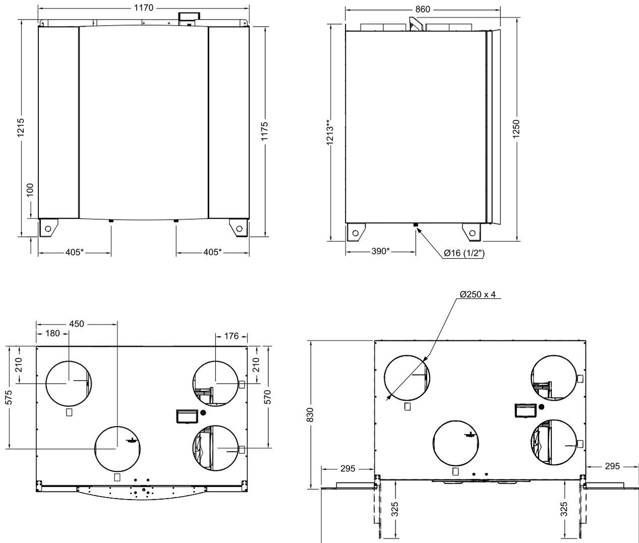
Bild 2 Abmessungen des Gerätes der Ausführung Zuluft rechts
