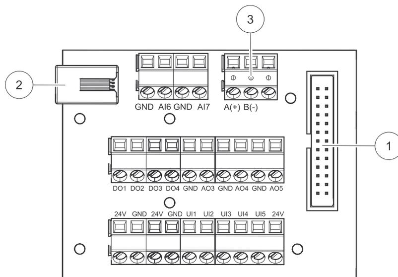
Bild 7 Außenliegenden Anschlussbox und Platine.
