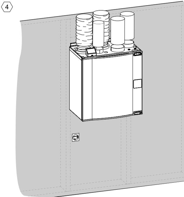
Beachten Sie beim Anschluss des Gerätes an das Kanalsystem die Lüftungszeichnung.
