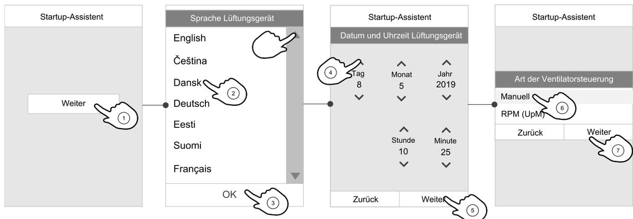
Wählen Sie die Sprache, stellen Sie die Uhrzeit ein und wählen Sie den Typ der Luftvolumenstromregelung. Wählen Sie die Drehzahl pro Minute als Art der Luftvolumenstromregelung nur dann, wenn diese Werte im Gerät enthalten sind.
