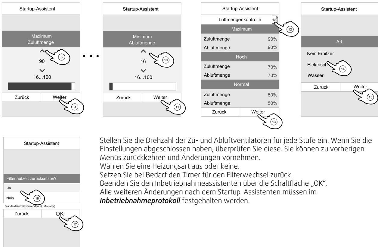
Stellen Sie die Drehzahl der Zu- und Abluftventilatoren für jede Stufe ein. Wenn Sie die Einstellungen abgeschlossen haben, überprüfen Sie diese. Sie können zu vorherigen Menüs zurückkehren und Änderungen vornehmen.
