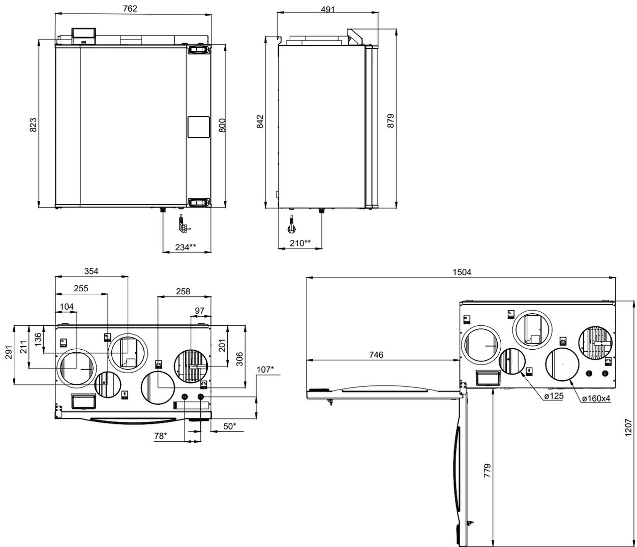
Bild 3 Abmessungen des rechtsseitigen Geräts
