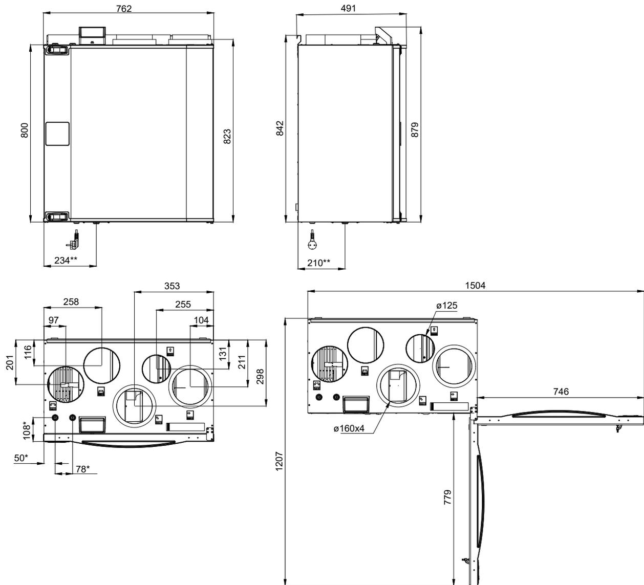
Bild 2 Abmessungen des linksseitigen Geräts
