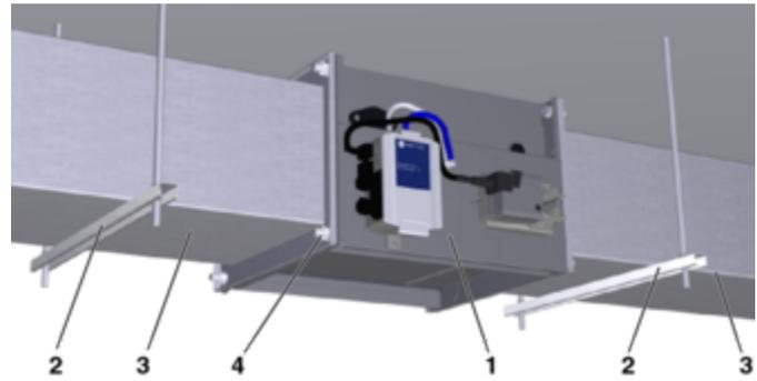
Abb. 10: Einbaubeispiel Aufhängung an Luftleitung
