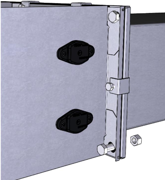
Abb. 15: Flanschverbindung
