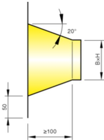
Abb. 9: Abmessungen Einströmhilfe [mm]
